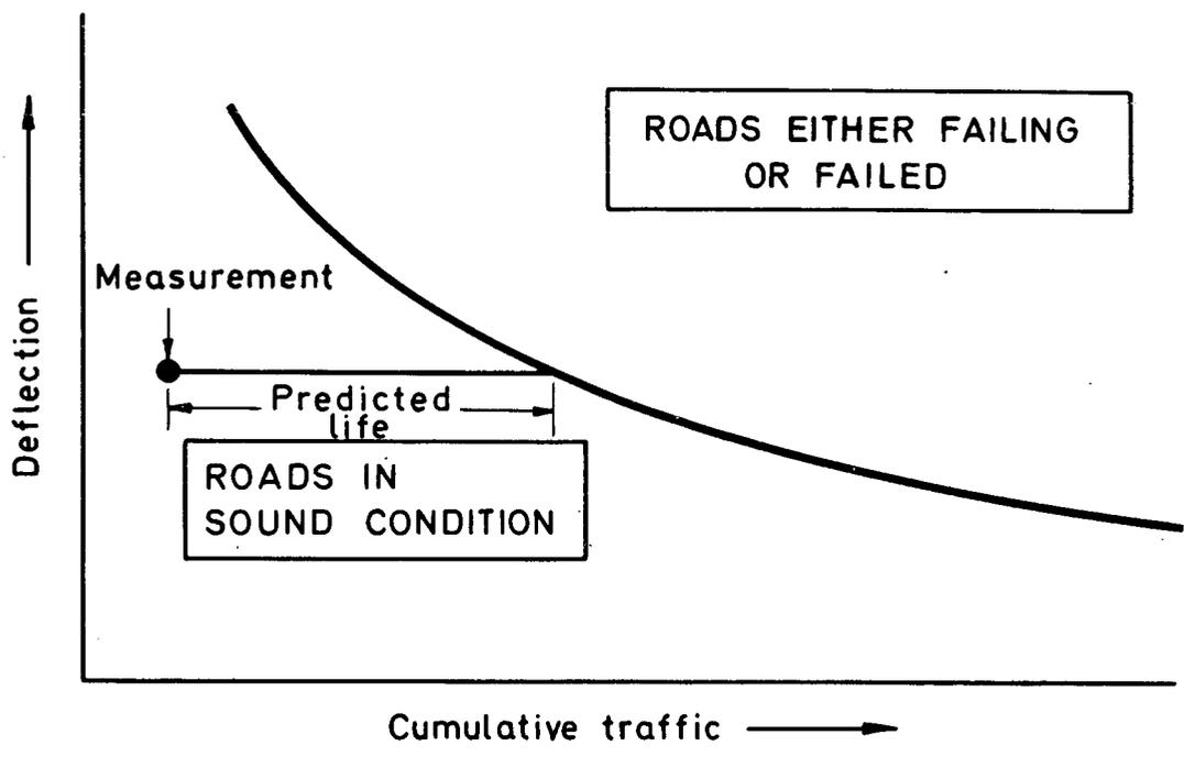
Fig. 1. THE DEFLECTION CRITERION CURVE
