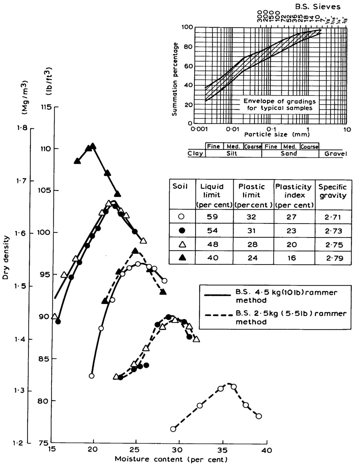
Fig. 2. CLASSIFICATION AND COMPACTION DATA FOR TYPICAL SOIL SAMPLES FROM SCHEME No.1
