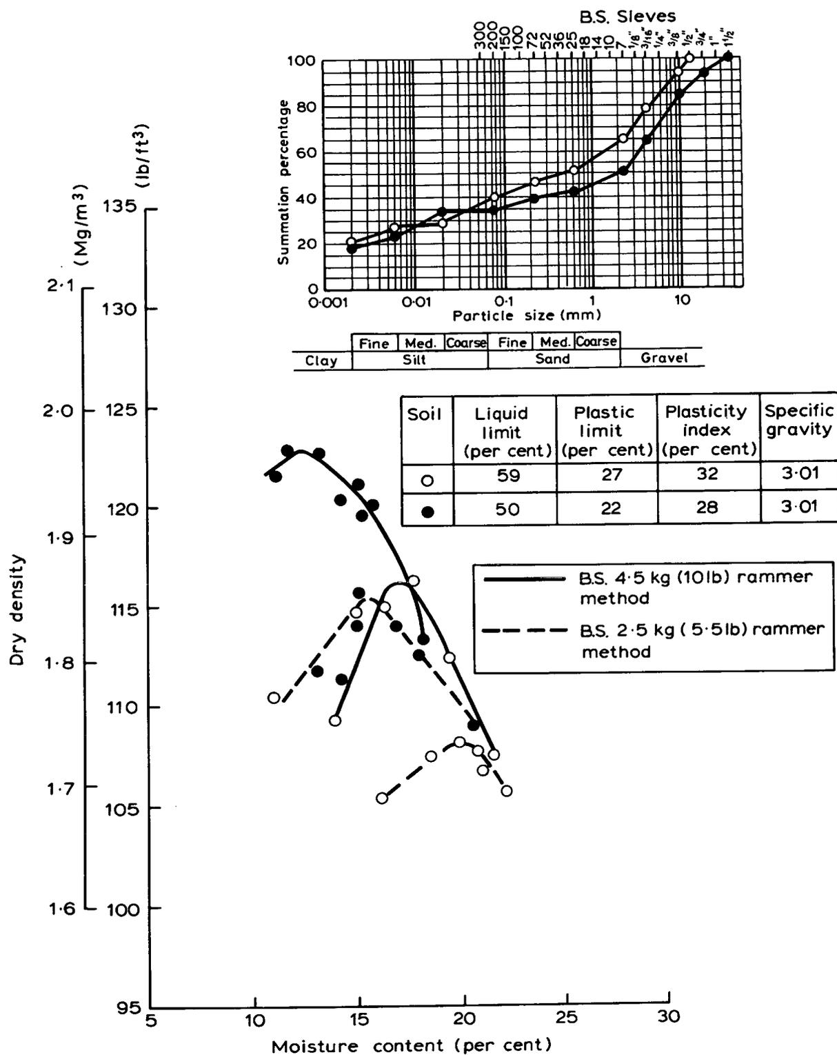
Fig.9 CLASSIFICATION AND COMPACTION DATA FOR TYPICAL STABILIZED SOIL SAMPLES FROM SCHEME No 8
