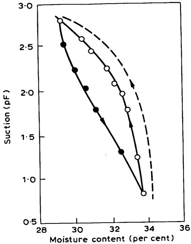
Fig. 21. SUCTION/MOISTURE CONTENT RELATION FOR HEAVY CLAY SOIL
