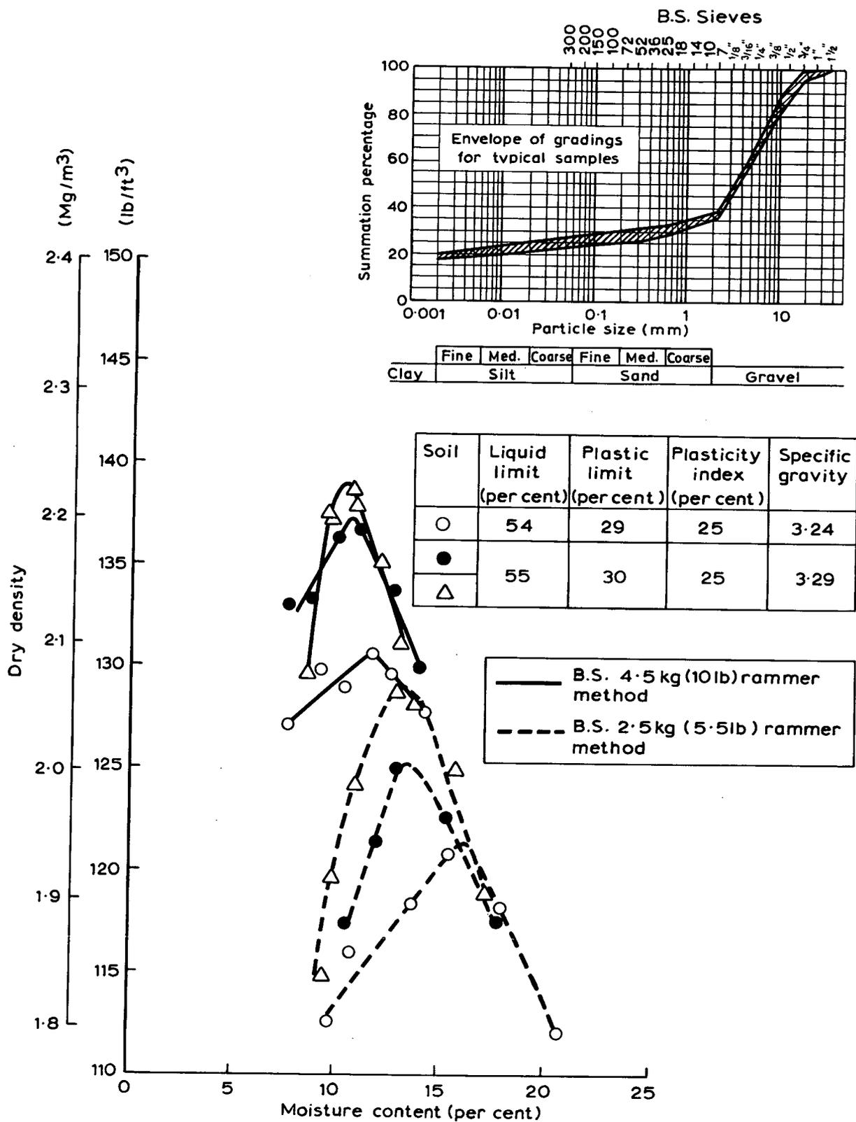
Fig. 6. CLASSIFICATION AND COMPACTION DATA FOR TYPICAL STABILIZED SOIL SAMPLES FROM SCHEME No.4
