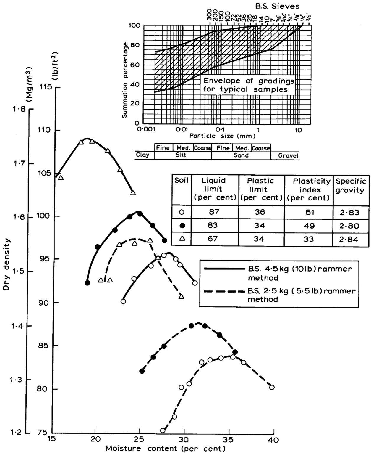
Fig. 10. CLASSIFICATION AND COMPACTION DATA FOR TYPICAL SOIL SAMPLES FROM SCHEME No.9
